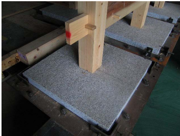
写真 2. 1-2 試験体 No. 5 柱脚（石場建て）
