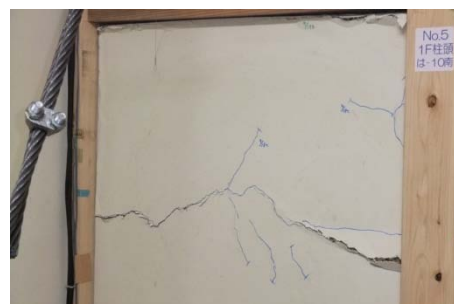
(a) 野帳の記録 (b) 損傷箇所のマーキング 図 2.3.4-2 野帳の記録方法と損傷箇所のマーキング例
