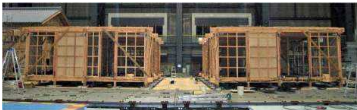
写真 2.3.1-2 振動台に設置された試験体 No.1 および No.2
