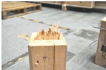
床束ほぞ、ほぞ折損 写真 06 ト-5, 床束ほぞ
