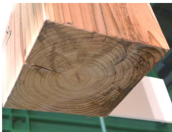
写真 4. 2. 1-17 礎石・切り出し 柱底面
