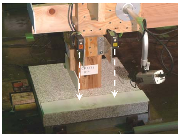
写真 4. 2. 1-11 鉛直方向のレーザー変位計
