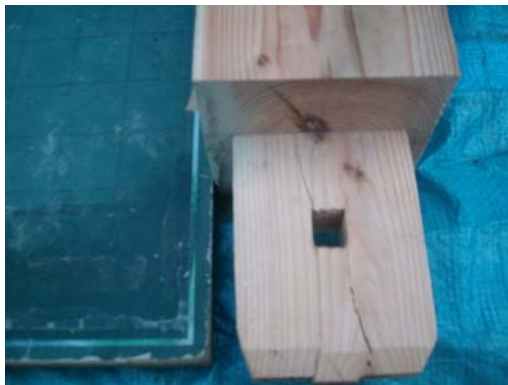
写真 4. 3. 4-5 MWD5-1 のほぞの破壊
