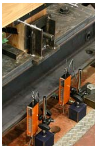
写真 4.3.5-3 柱脚の鉛直変位の計測状況
