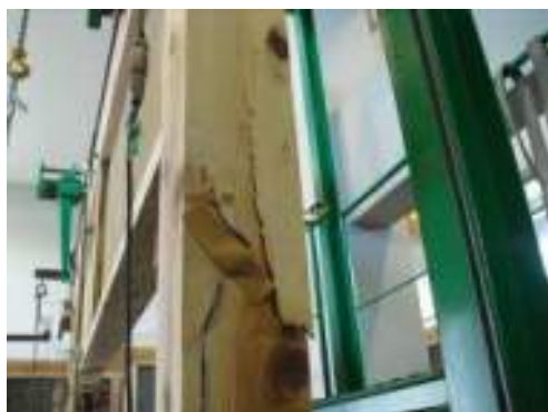
写真 4. 3. 6-50 左柱の折れ +1/15[\text{rad}] (PWD11)
