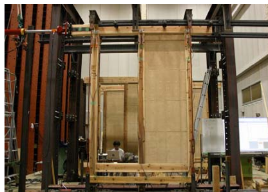
写真 4.3.5-1 足固仕様乾式試験体の実験状況
