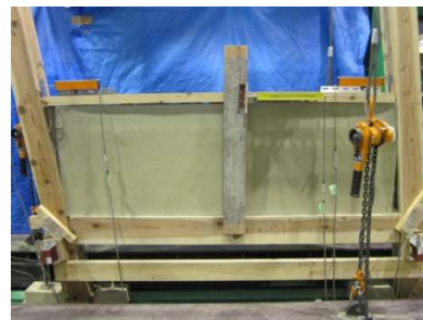
写真 4.3.3-5 腰壁 +1/7[rad] (1 体目)
