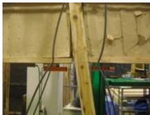
写真 4. 3. 6-64 鴨居-中柱 -1/7[\text{rad}] (PWD12)
