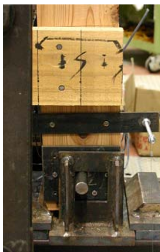
写真 4.3.5-2 柱脚浮上り拘束の状況
