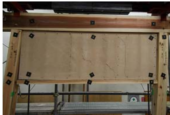
写真 4. 3. 6-2 1/10\text{rad} 時のパネル (PWD-4)
