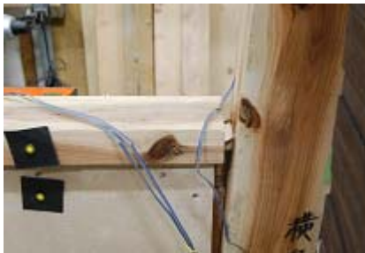
写真 4. 3. 6-1 窓台端部の抜け (PWD-5, +1/15rad 時)
