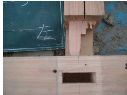
写真 4. 3. 4-6 MWD4-3 のほぞの破壊
