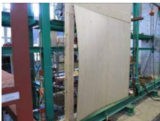
写真 4. 5. 2-11 鉛直荷重制御式 (1/30rad)
