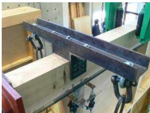
写真 4.5.1-3 鉛直載荷治具
