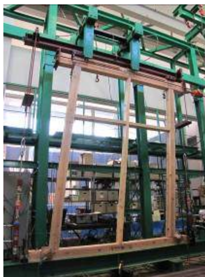
写真 4.5.2-14 鉛直荷重制御式 (1/10rad)
