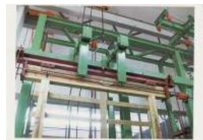
写真 4. 5. 1-7 鉛直载荷治具
