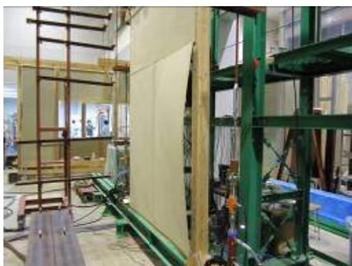
写真 4. 5. 2-7 鉛直荷重制御式 (1/50rad)
