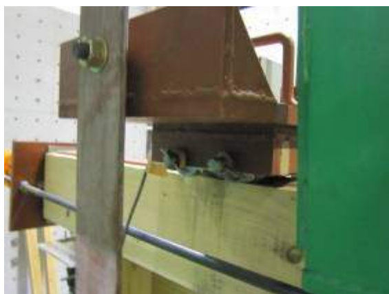
写真 4. 5. 1-2 タイロッド上部ローラー
