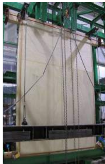
写真 4.5.1-4 鉛直載荷の様子
