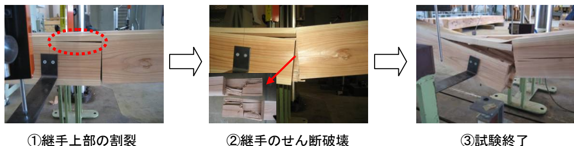
図 4.6.6-14 破壊の進行状況例 (F-⑩-2 試験体)
