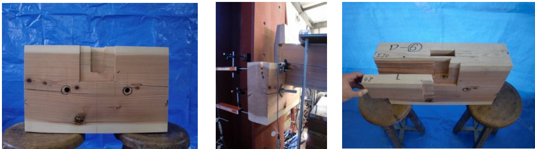
写真 4. 6. 3-4 試験体Ⅰ（加力前の桁、加力中の桁の割れ、加力後の桁）
