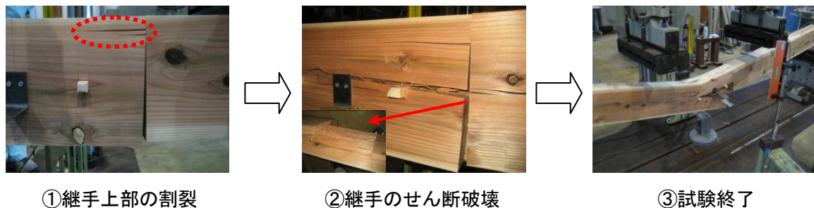
図 4.6.6-13 破壊の進行状況例 (F-⑩-1 試験体)
