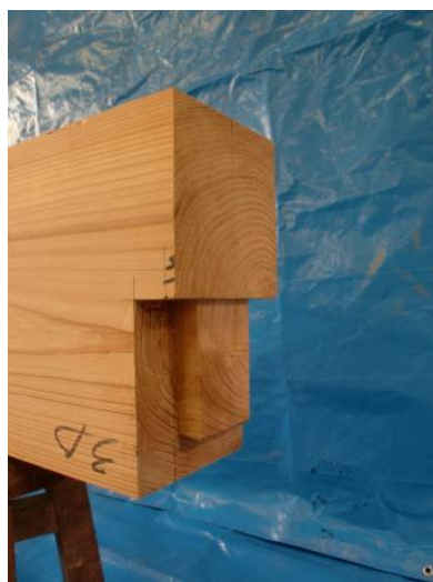
写真 4. 6. 3-1 载荷前の梁の仕口部分
