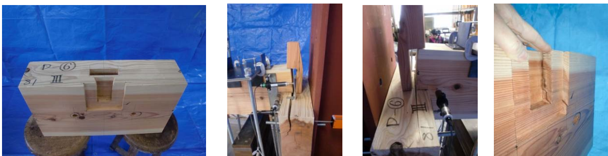
写真 4. 6. 3-6 試験体Ⅲ（加力前の桁の前面、加力中の桁右側の割れ、加力中の桁左側の割れ、加力後の桁）
