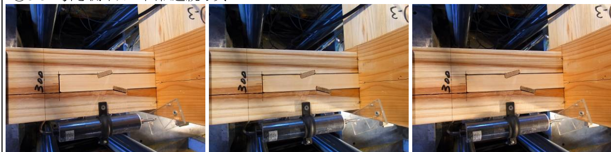
B①3-1 押し側車知の回転連続写真（あまり明確な変形は見られない）
