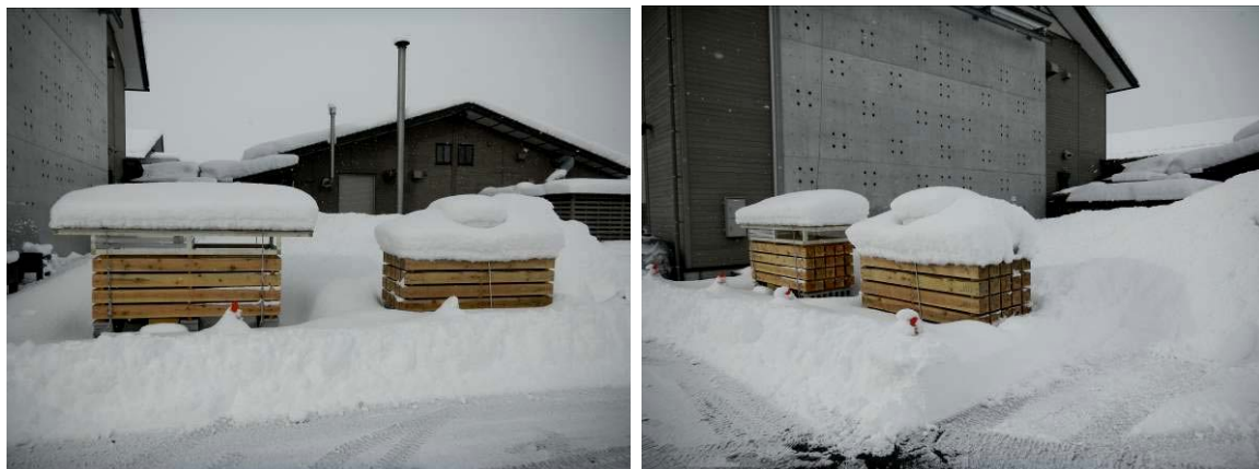
写真 6. 2. 3-7 栈積み試験体の積雪
