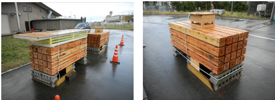
写真 6. 2. 3-5 温湿度センサの追加防風措置
