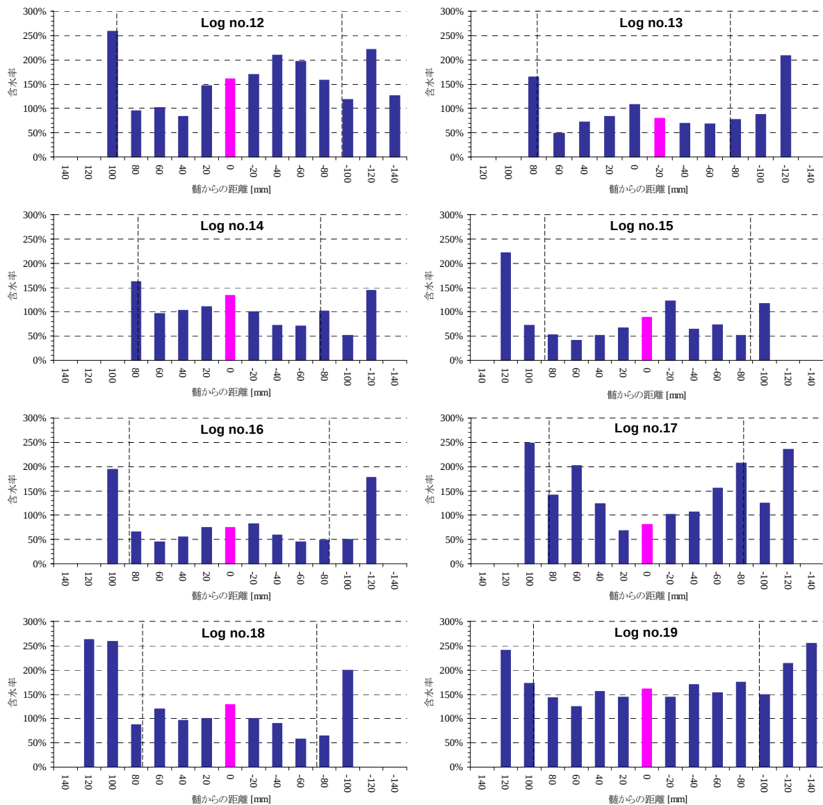
図 6.2.2-6 伐採直後の葉枯らし用材の樹幹内含水率分布
