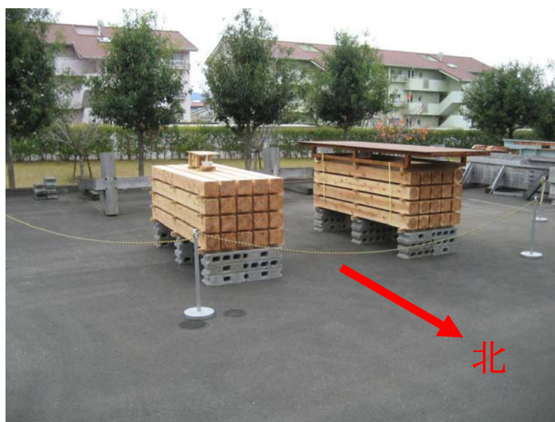
写真 6. 2. 4-1 栈積み試験体の屋外暴露状況
