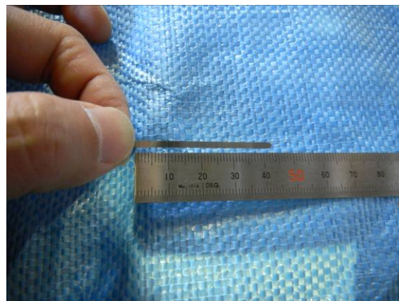
e) 割れ深さの読み取り
