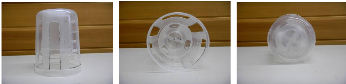
a) ディスポカップ 2 重構造によるセンサ保護用カバー
