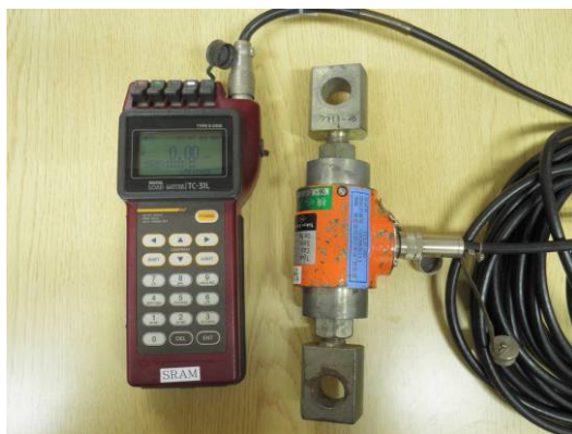
写真 6. 2. 2-3 東京測器製引張型荷重計と現場用デジタルロードメータ
