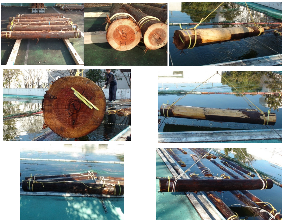
写真6. 2. 1-8 水中前処理乾燥試験体の水中処理の状況
