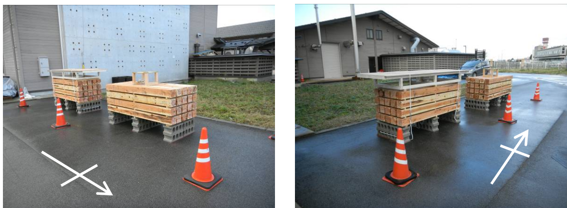
写真 6.2.3-3 栈積みの屋外暴露状況
