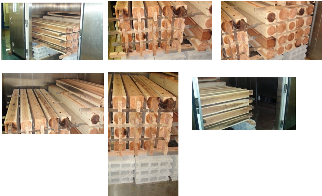
写真6. 2. 1-7 屋内常態乾燥及び生材加工後常態乾燥の状況
