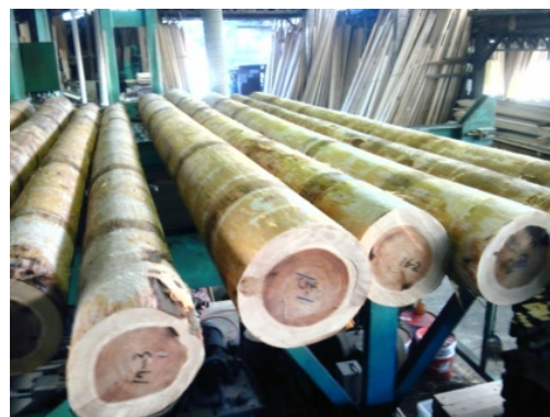
写真6. 2. 1-4 原木の選別と粗挽き製材の状況
