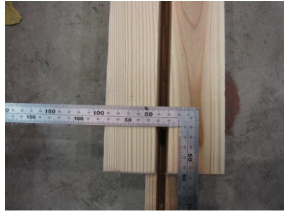
写真 6. 2. 1-7 実験後の背割れ幅
