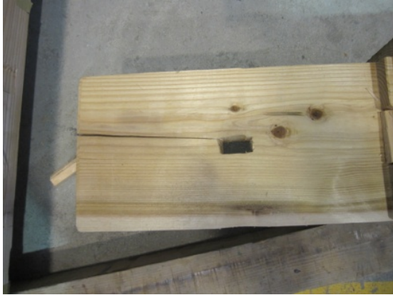
写真 6. 3. 1-6 柱ほぞのひび割れ
