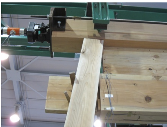
写真 6. 3. 1-4 差し鴨居と鼻栓の様子
