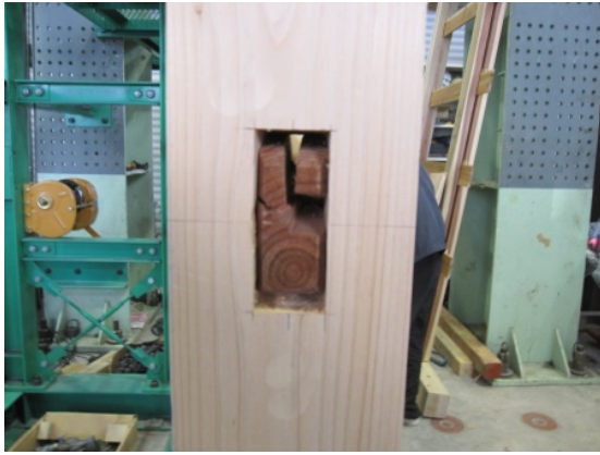
写真 6. 2. 1-6 柱ほぞ小口の割れ
