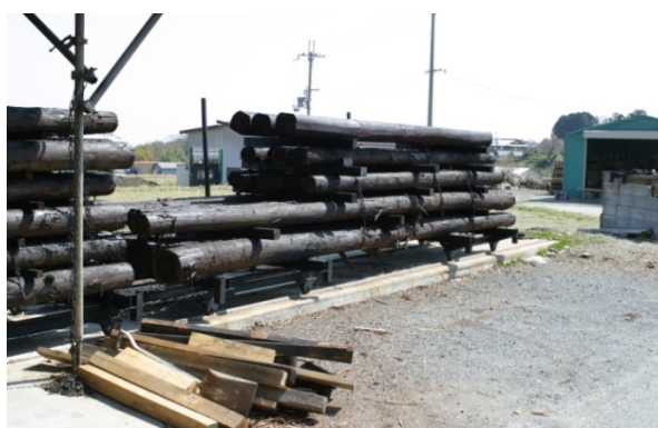
写真 6.4.3-13 燻煙熱処理後のスギ丸太の樹皮
