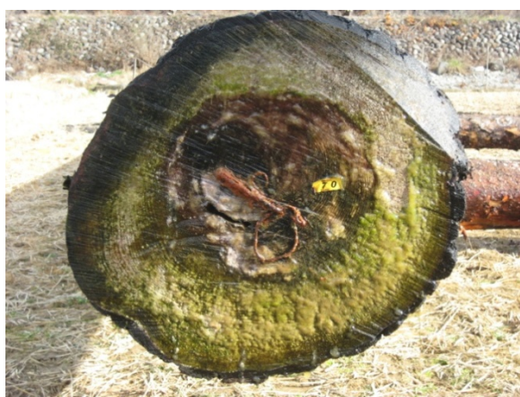
写真 6. 4. 3-25 水中処理後の元口の樹液状況
