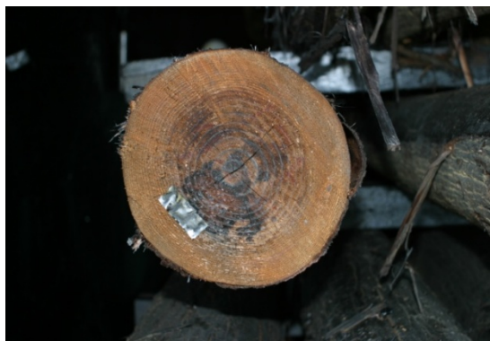
写真 6.4.3-14 燻煙熱処理後の丸太木口の割れ
