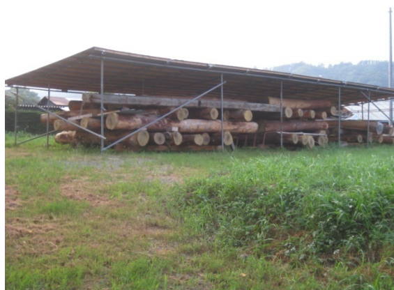
写真 6. 4. 3-32 アカマツ丸太の天然乾燥の全景
