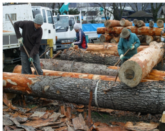
写真 6.4.3-28 アカマツ丸太の樹皮の剥皮作業
