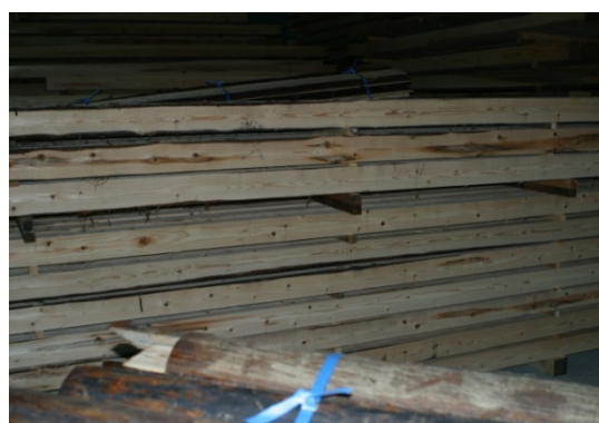
写真 6.4.3-15 燻煙熱処理後の製材（正角材）
