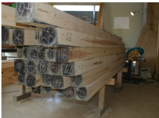
写真 6.4.3-18 3寸5分角の自然乾燥状況
