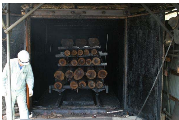
写真 6.4.3-12 燻煙熱処理後のスギ丸太の木口
