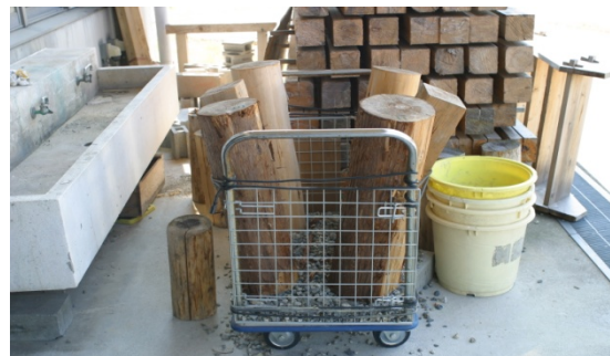
写真 6.4.3-4 3 種のスギ材の天然乾燥の状況
