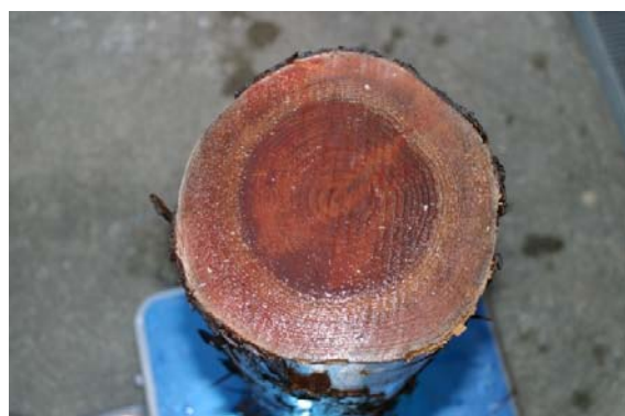
写真 6.4.3-6 心材部から滲み出てくる樹脂
