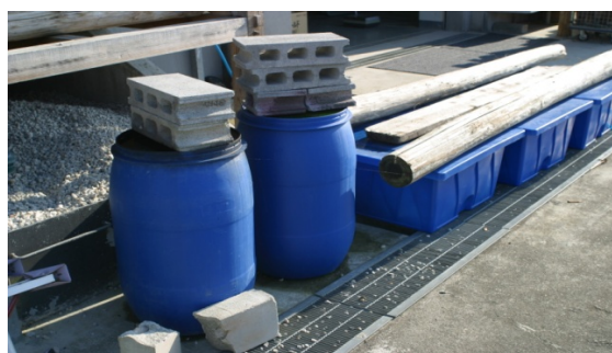
写真 6.4.3-3 3 種のスギ材の水中処理の状況
