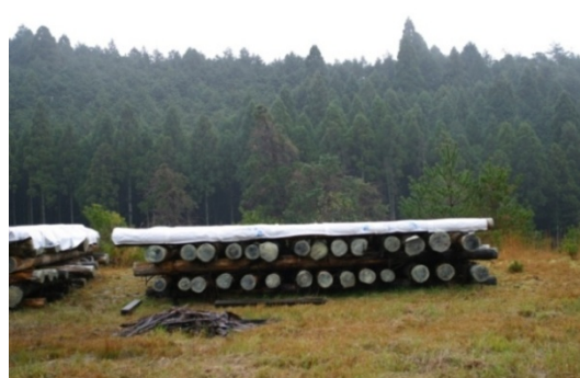
写真 6.4.3-9 スギ丸太の自然乾燥状況
