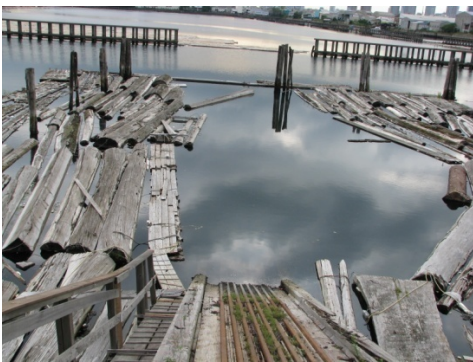
写真 6.4.3-1 鴨川商店の海を利用した水中貯木 写真 6.4.3-2 山田工作所でのヒノキの水中貯木
