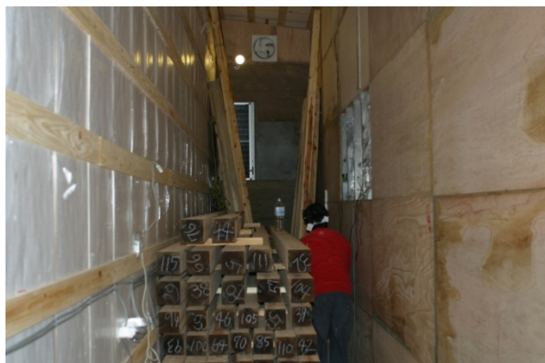
写真 6.4.3-16 自然乾燥専用倉庫での乾燥
