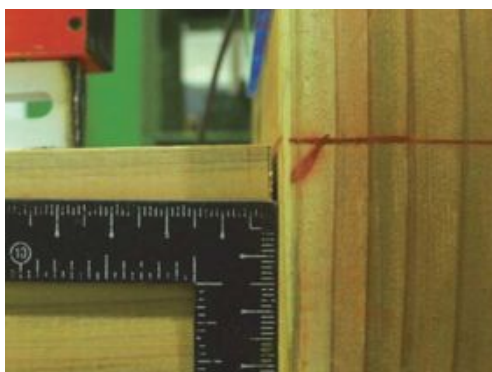
(c) 右側鴨居と柱の隙間
