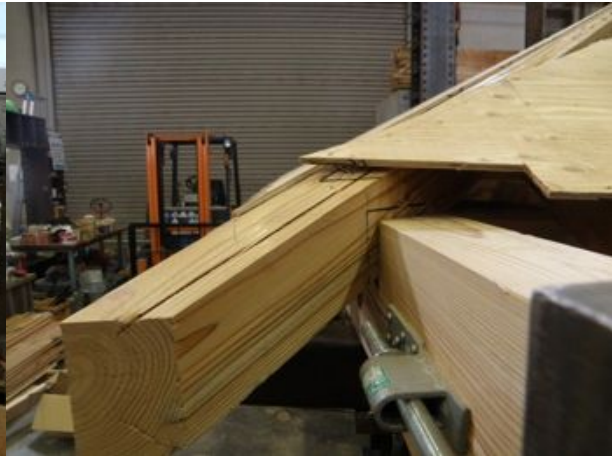
隅木－桁接合部
