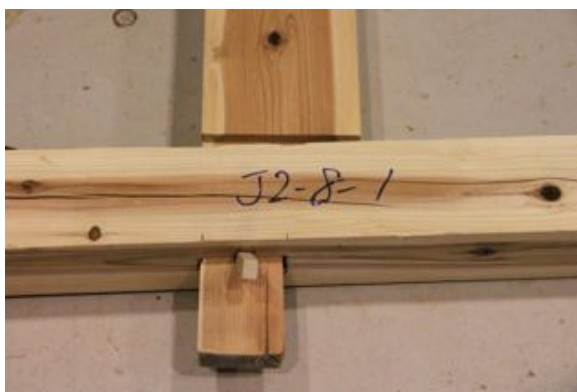
写真3. 4. 2-57 鼻栓が折れたがホゾは破壊せず (J2-8-1)
