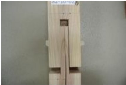
(c) ホゾのせん断による試験体の破壊 試験体：M2-10-02
