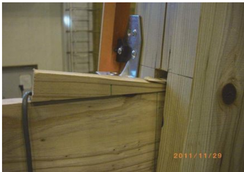
写真3. 5. 2-7 くさびの食い込みと割れ (MWDF-3、 -1/10\text{rad} )
