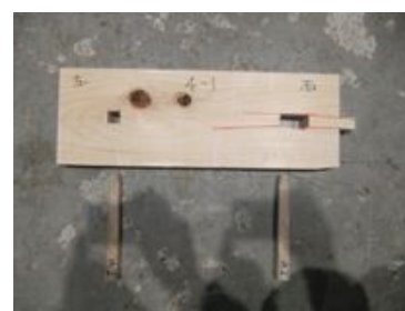
写真3. 4. 2-22 梁のほぞ部の抜け出しながら荷重が低下したケース（押し方向加力）
