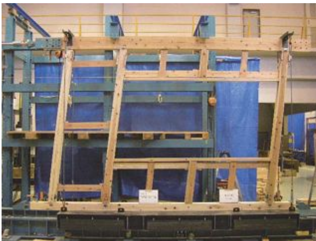
写真3. 5. 2-5 最終変形状況（MWDF-11）
