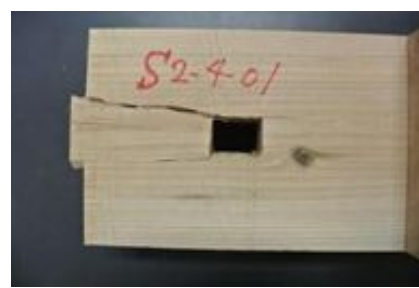
(f) ホゾのせん断破壊③ 試験体：M2-4-01, L1=90mm
