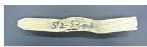
込み栓の曲げ破壊 (h) 込み栓の年輪方向と破壊性状② 試験体：M2-5-03, 18mm角栓, 加力方向に対する込み栓の年輪が直交方向
