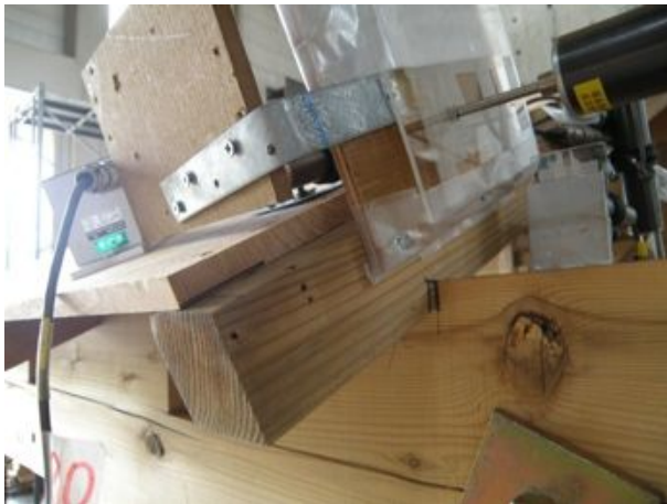
垂木－桁接合部
