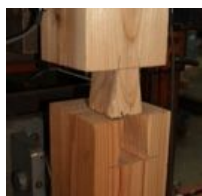
女木の繊維方向の割裂
