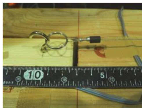
(b) 左側雇いの隙間
