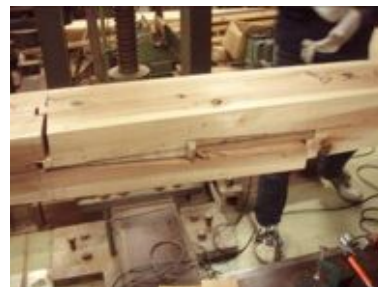
写真3. 4. 2-93 D1-14損傷状況
