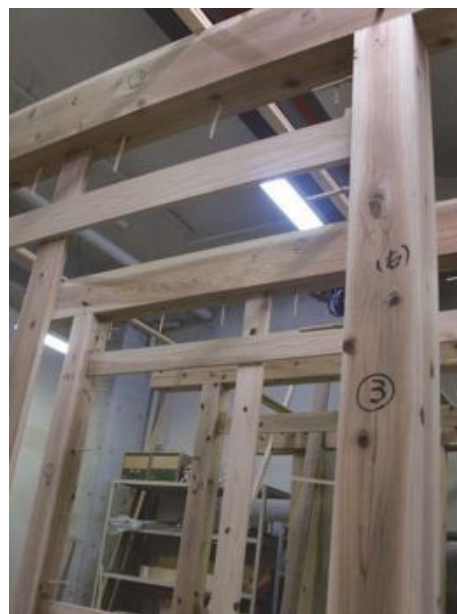
(b) 柱、梁に打ち込まれた「ウグイス」
