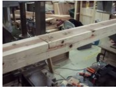
写真3. 4. 2-86 D1-14-3損傷状況
