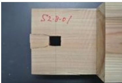
(e) ホゾのせん断破壊② 試験体：M2-8-01, L1=45mm
