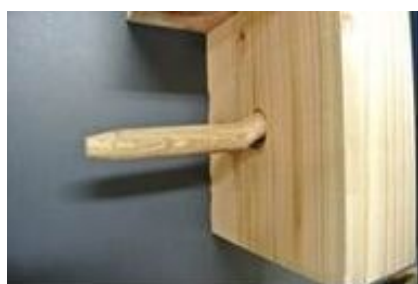
(a) 込み栓の曲げ破壊 (試験体: M1-1-01)
