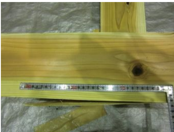
写真3. 4. 2-49 J5No7-3加力前 柱のめくれ
