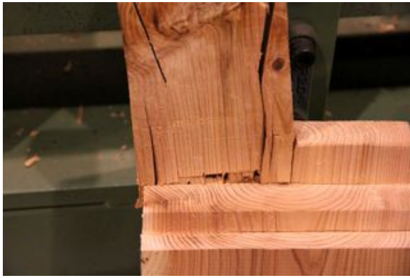
写真3. 4. 2-65 楔から割裂、ホゾの根元が折れ (J4-1-1)
