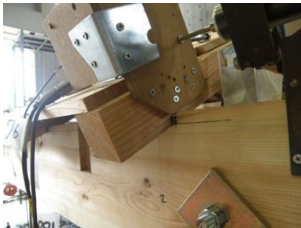
垂木－桁接合部
