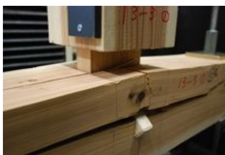
(c) 割裂が生じた土台
