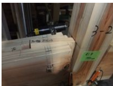
写真3. 4. 2-20 込栓が曲げ破壊したケース（引き方向加力）
