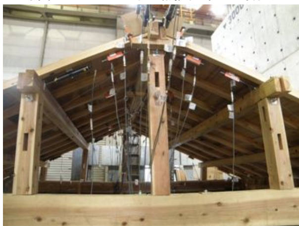
写真3. 4. 1-31 RGCOの小屋束の傾斜
