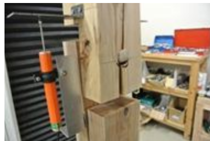
(d) 主材の割裂破壊 (M1-3-01)
