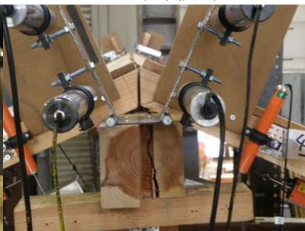
垂木－棟接合部
