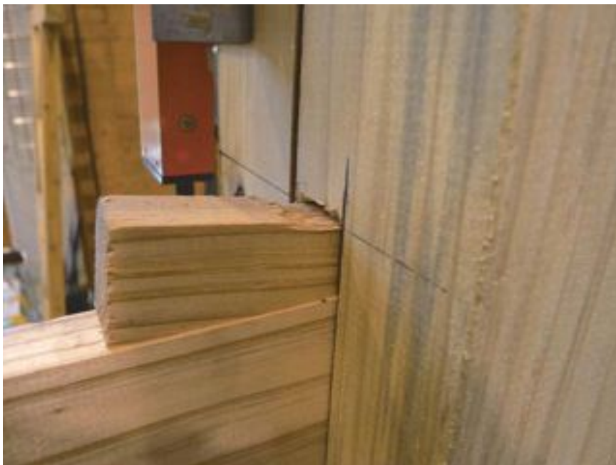
写真3. 5. 2-3 くさびのつぶれ (1/15rad時、1体目)
