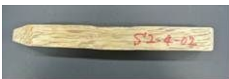
込み栓の微小な曲げ変形 (g) 込み栓の年輪方向と破壊性状① 試験体：M2-4-02, 18mm角栓, 加力方向に対する込み栓の年輪が平行方向
