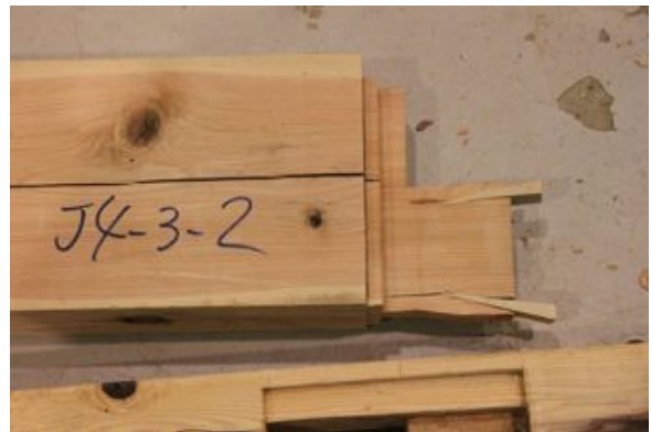
写真3. 4. 2-68 ホゾの引き抜け、ホゾには大きな 損傷なし (J4-3-2)
