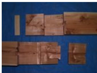
鎌部分のせん断破壊
