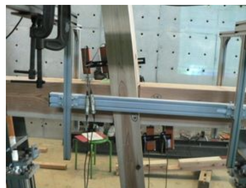
(16) 変形角+1/7rad 柱の変形
