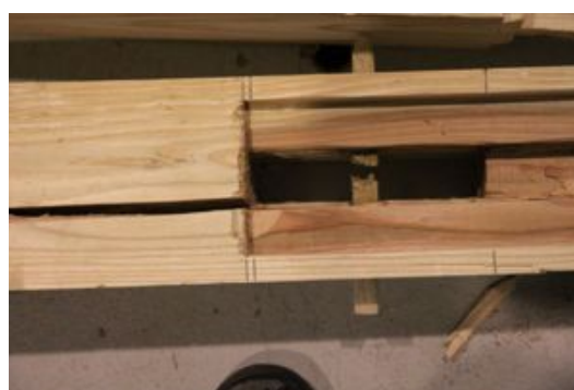
写真3. 4. 2-64 込み栓が折れ、ホゾはめり込みのみ (J3-4-2)
