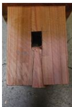
(a) せん断破壊が生じたほぞ (b) 曲げ破壊後せん断変形した込栓
