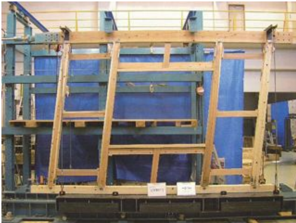
写真3. 5. 2-6 最終変形状況 (MWDF-7)
