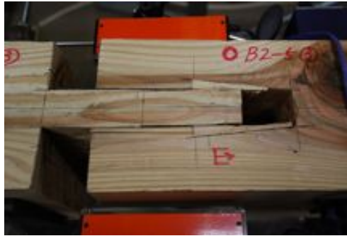
写真3.4.2-117 男木のせん断破壊
