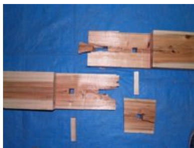
孔部分の端抜け破壊（角栓）
