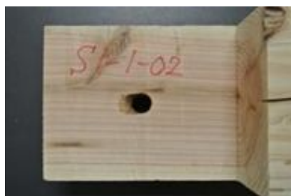
(c) 込み栓穴のめり込み変形 (M1-1-02)
