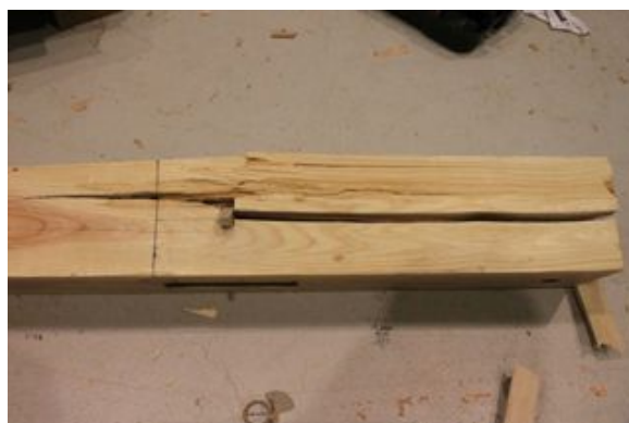
写真3. 4. 2-63 込み栓から柱端部まで亀裂が進展 (J3-4-1)
