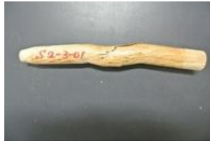
(b) 込み栓の曲げ破壊 試験体：M2-3-01
