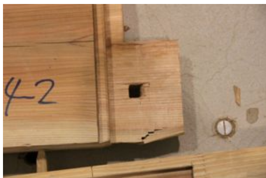
写真3. 4. 2-64 込み栓が折れ、ホゾはめり込みのみ (J3-4-2)
