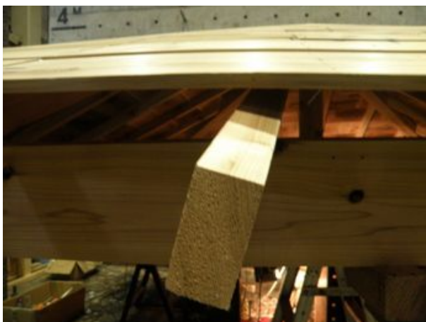
垂木一桁接合部
