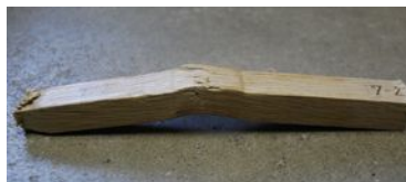
(a) せん断破壊が生じたほぞ (b) 曲げ破壊後せん断変形した込栓
