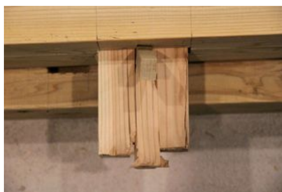
写真3. 4. 2-55 鼻栓からホゾが割裂 (J2-1-2)
