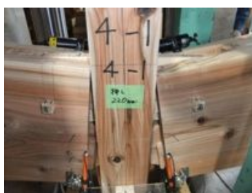
写真3. 4. 2-22 梁のほぞ部の抜け出しながら荷重が低下したケース（押し方向加力）
