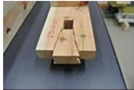
(d) ホゾのせん断破壊① 試験体：M2-10-01
