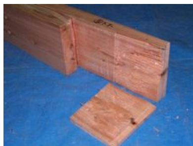
鎌部分のせん断破壊
