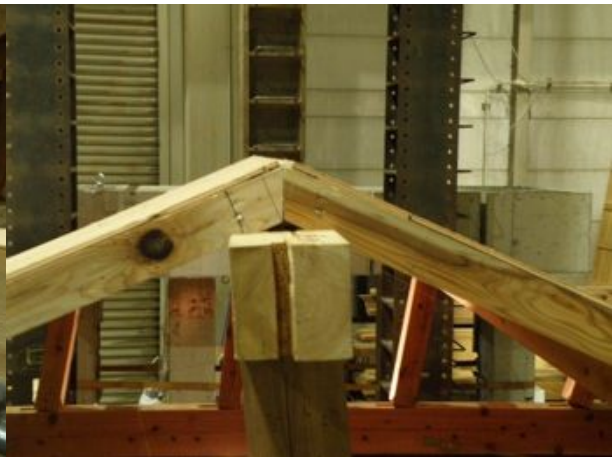
垂木－棟接合部
