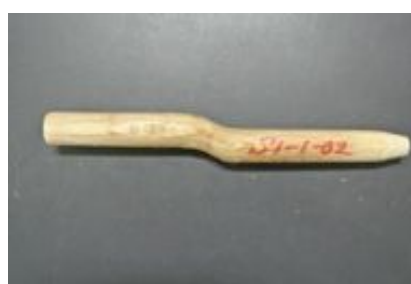
(b) 込み栓の曲げ破壊 (M1-1-01)
