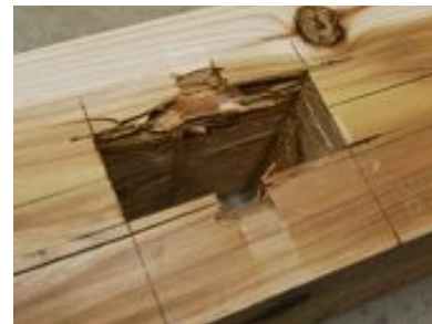
(d) 折れた込栓がほぞ穴の縁にめり込んだ跡
