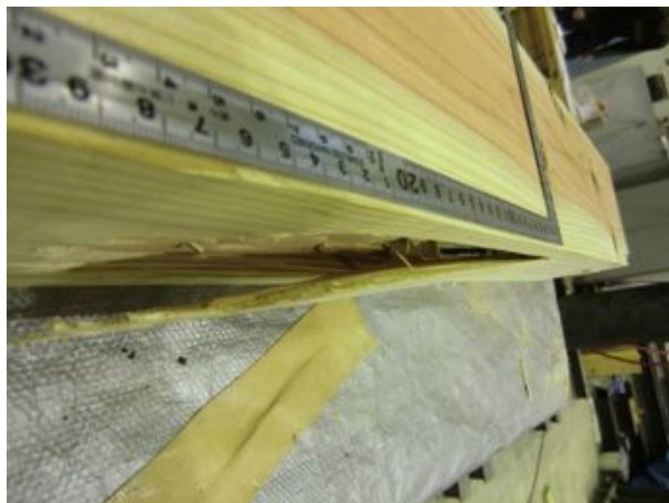
写真3. 4. 2-50 J5No7-3加力前 柱のめくれ（楔が沈んでいる）
