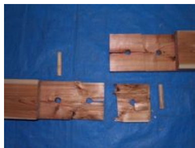
孔部分の割裂破壊（丸栓）
