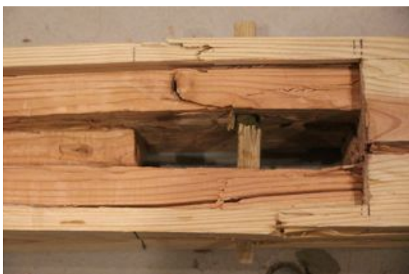
写真3. 4. 2-62 柱が込み栓部分で曲げ破壊 (J3-4-1)
