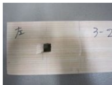
写真3. 4. 2-20 込栓が曲げ破壊したケース（引き方向加力）
