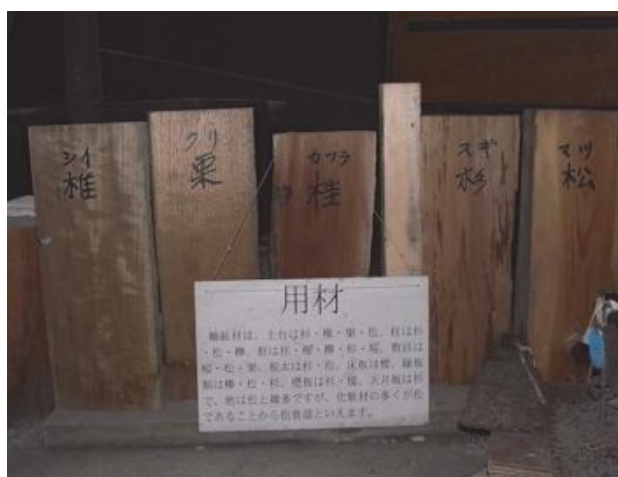
写真4. 2. 10-15 軸組材 化粧材の多くが松であることから松普請といえる
