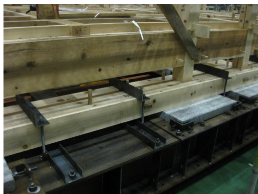
写真 2.3.2-3 石場建て地長押仕様 (柱脚固定)
