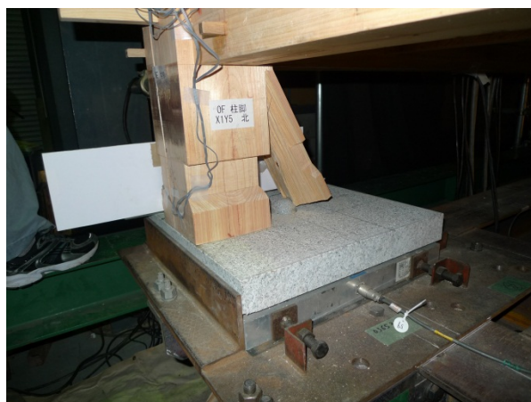
写真 3.3.2-15 JMA 神戸波加振での柱脚割裂 2
