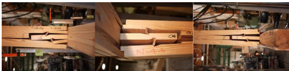
写真 3.4.3-14 実験における破壊の様子
