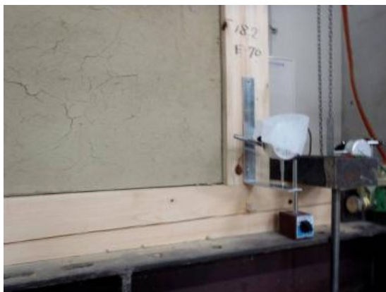
(a) 表面チリ部の隙間 (1/120)
