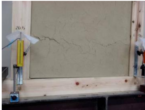
(g) 繋がった下貫付近の亀裂と浮き始めた土壁と左の柱(1/45)
