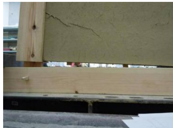
(n) 土台から抜けた柱と間渡し(1/20)
