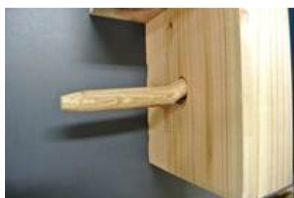
(a) 込み栓の曲げ破壊
