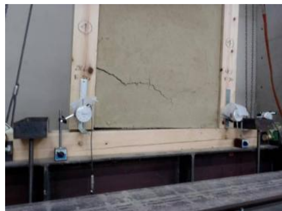
(p) 抜け始めた左の柱の抜け状況(1/30)
