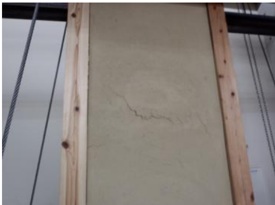
(g) 中貫付近の亀裂 (1/30)
