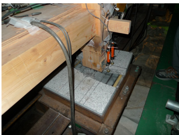
写真 3.3.2-16 JMA 神戸波加振での礎石の割れ
