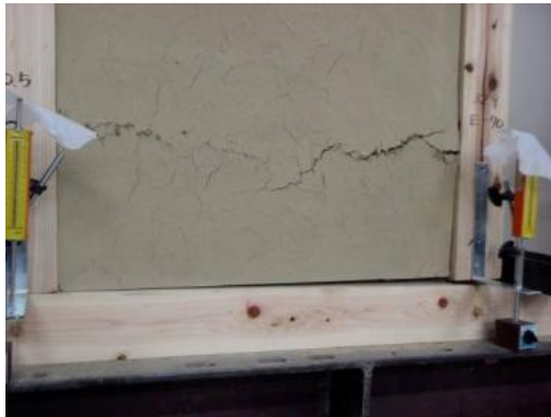
(h) 表面下貫付近の亀裂の進展(1/30)
