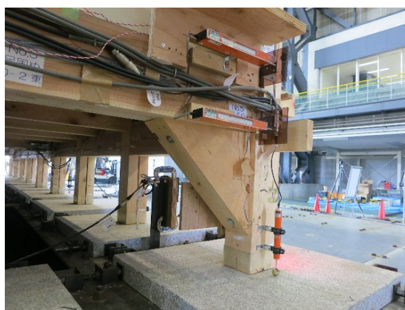
写真 3.2.4-5 持ち送りによる足固め下の補修
