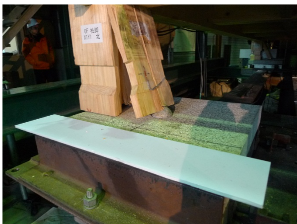
写真 3.3.2-14 JMA 神戸波加振での柱脚割裂 1
