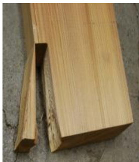
写真 3.4.3-10 鎌部せん断破壊
