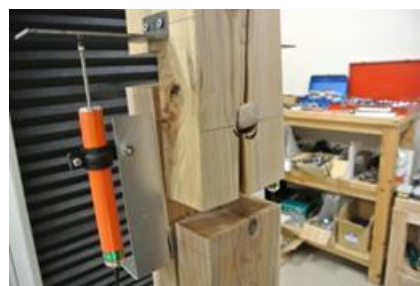
(d) 主材の割裂破壊
