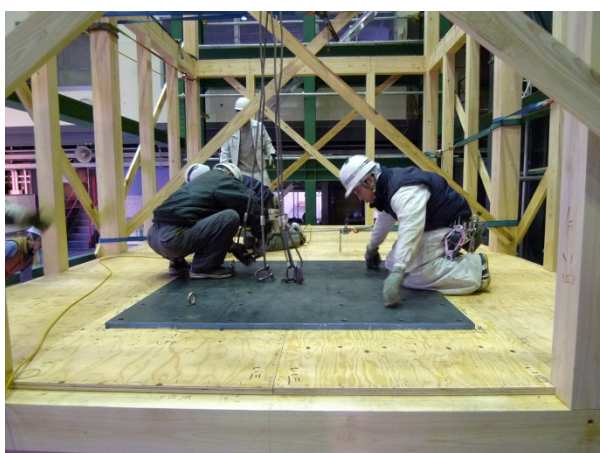
写真 3.3.2-6 鋼板錘の設置
