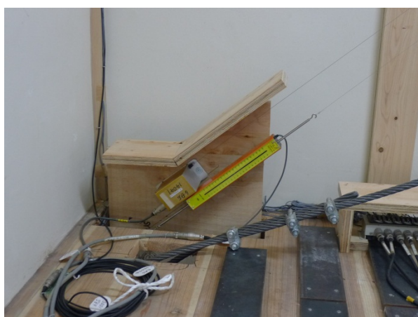
写真 3.2.3-2 層間変形角用変位計
