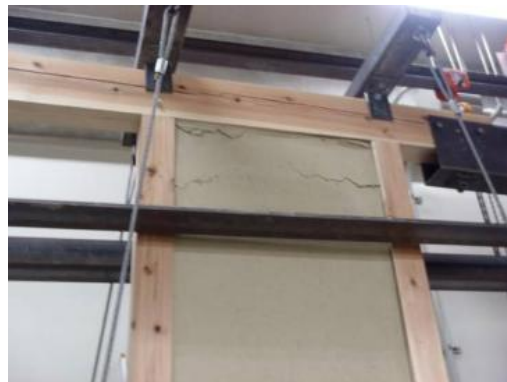
(k) 表面の上貫付近の亀裂の進行(1/20)
