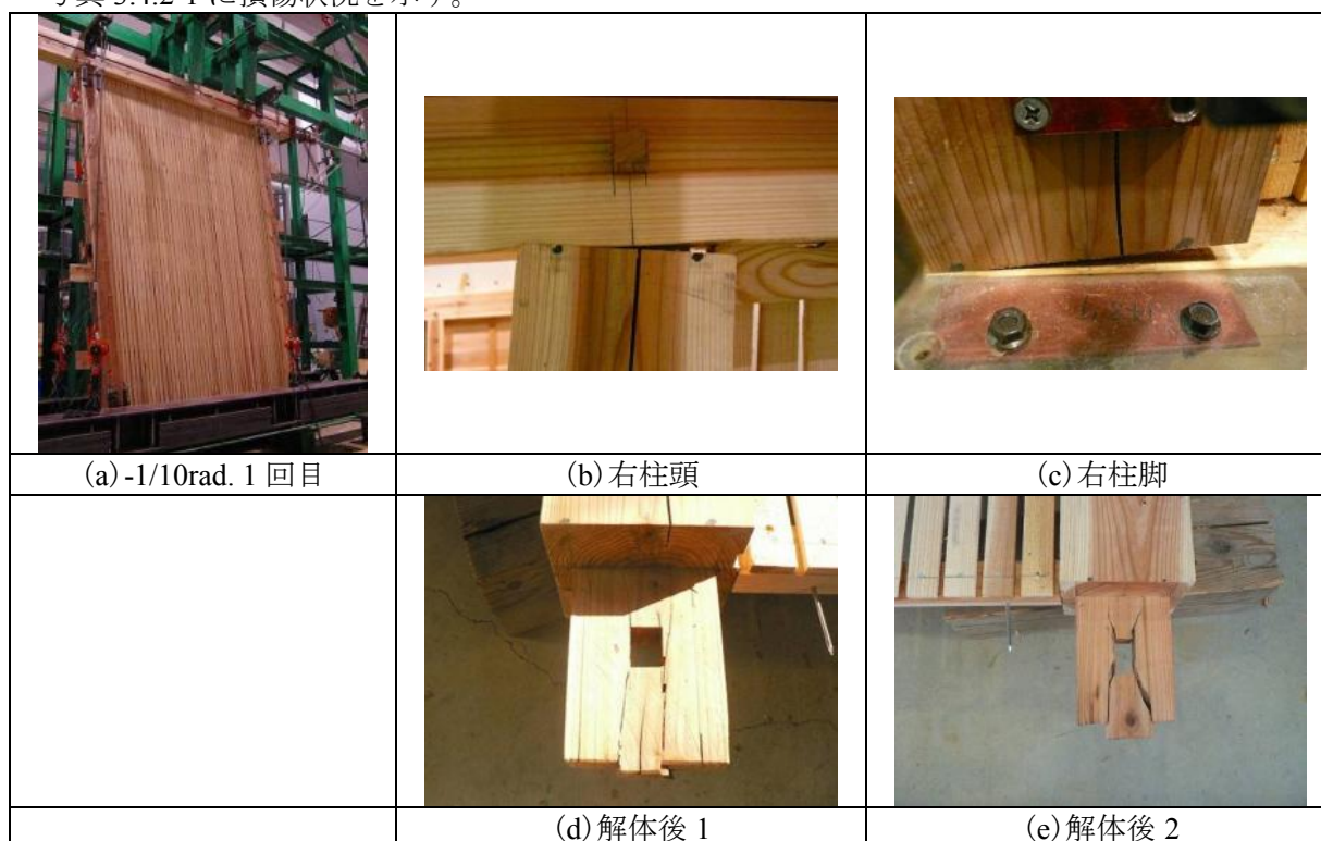
写真 3.4.2-1 LPW1-1 損傷状況
