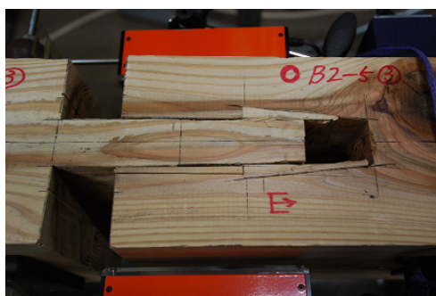
写真 3.4.3-2 男木のせん断破壊
