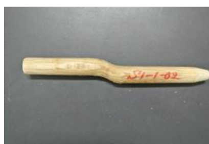
(b) 込み栓の曲げ破壊
