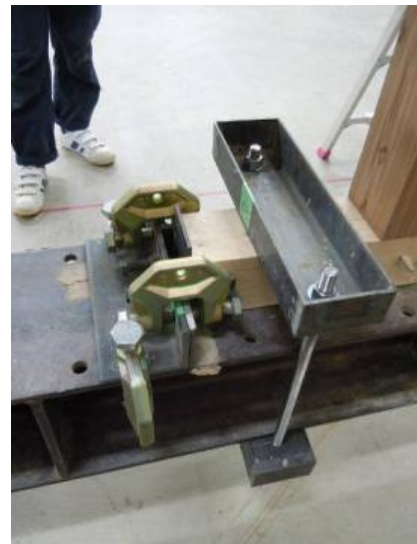
写真 3.5.1-26 土台の固定状況 試験体の設置状況
