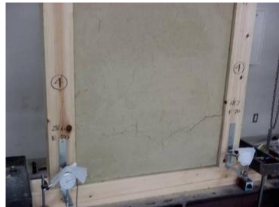
(j) 裏面の下貫付近の亀裂の進行(1/45)
