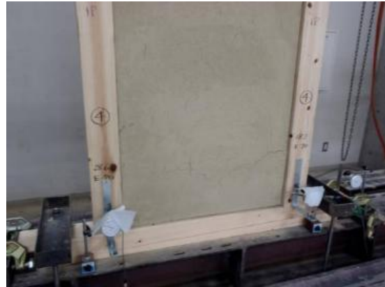
(f) 大きくなった表面の下貫付近の亀裂(1/60)
