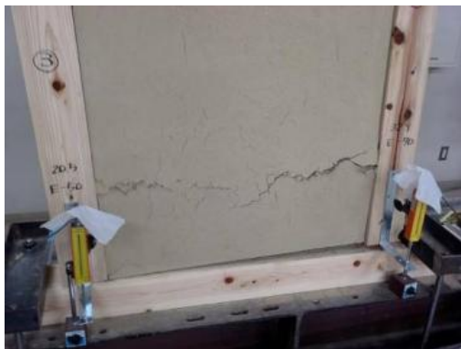
(j) 表面下貫付近の亀裂の進展(1/20)
