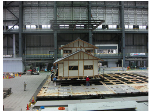
写真 3.2.2-52 試験体吊上げ
