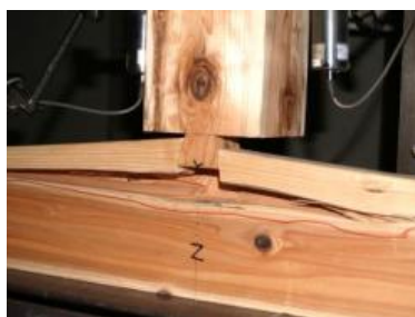
写真 3.4.3-1 蟻掛けの破壊性状
