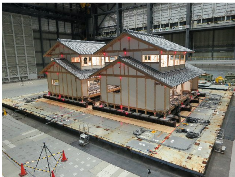
写真 3.2.4-1 震動台上の試験体 (左側：試験体 No.6、右側：試験体 No.5)
