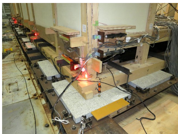
写真 3.2.4-2 柱脚固定状態 (溝型鋼およびボルトにて鉄骨架台に固定)
