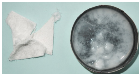
写真 3.6.6-1 紙スサを水に溶かした様子 ※左側に紙スサ 右側は水に溶かした状態。図中の中央下は、スサを集め溶けた状態を表す。
