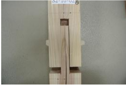
(c) ホゾのせん断による試験体の破壊
