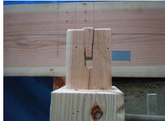
(r) 柄孔が抜けた左の柱(後日)
