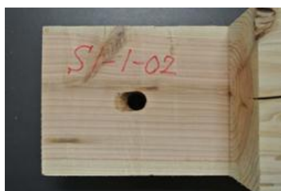
(c) 込み栓穴のめり込み変形
