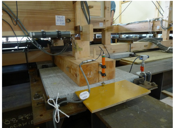
写真 3.2.3-6 柱脚の浮上り用変位計 (No.6)
