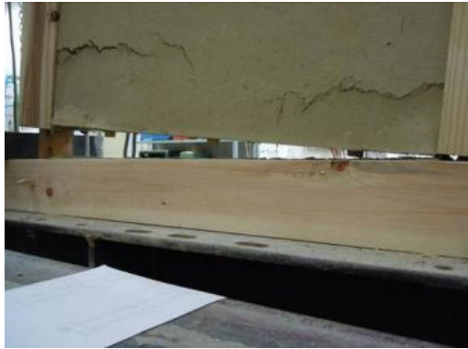
(l) 全て抜けた間渡し、抜けかけている柱(1/10)
