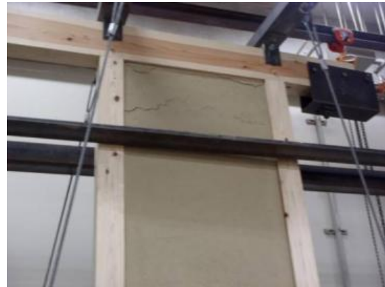
(l) 表面上貫付近の亀裂の進展(1/30)
