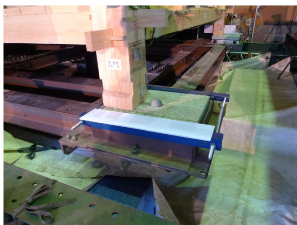
写真 3.3.2-17 JMA 神戸波加振でのダボ飛び越え
