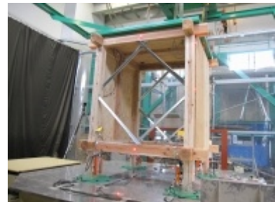
(f) 弱軸構面の鋼製筋かい
