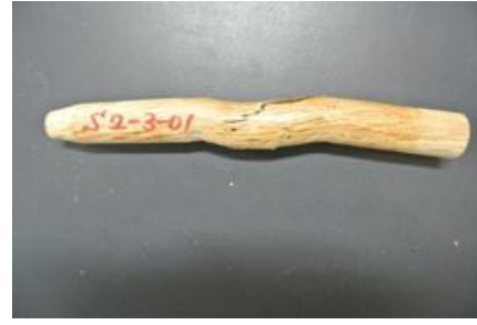
(b) 込み栓の曲げおよびせん断破壊
