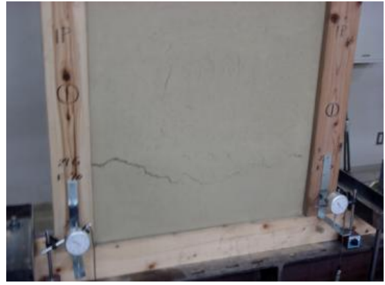
(d) 下貫付近の亀裂が繋がる (1/60)
