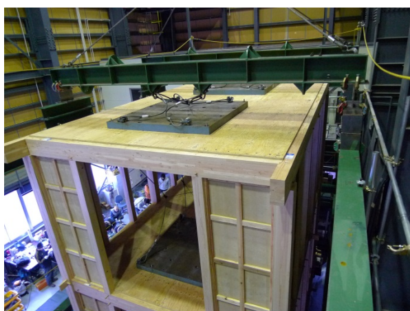
写真 3.3.2-7 RF の鋼板錘の設置状況
