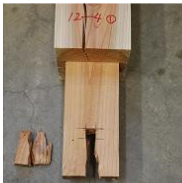
写真 3.4.3-12 ほぞのせん断破壊
