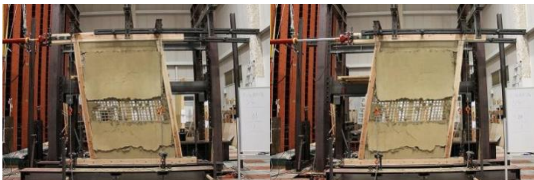
写真 3.5.1-32 土壁の損傷状況 (MWD-2-1812-1)
