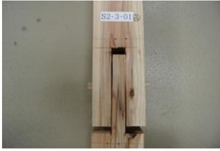
(a) 込み栓が曲げによる試験体の破壊
