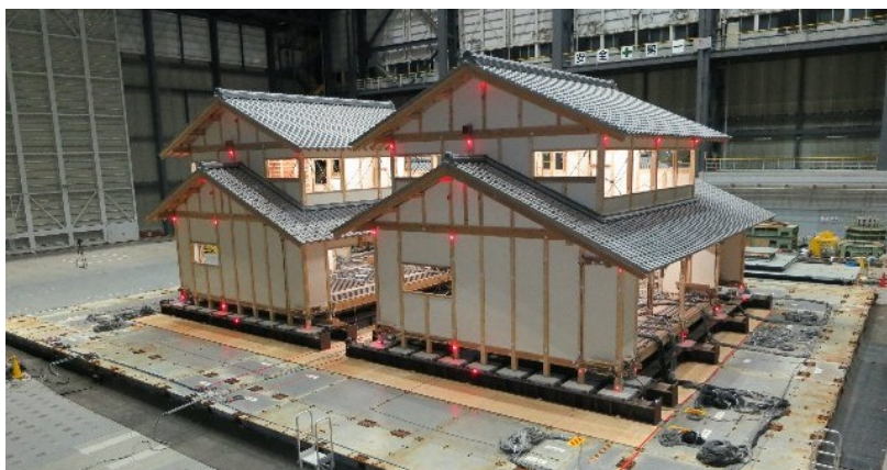
写真 1 振動台上の試験体 (左側：試験体 No.6、右側：試験体 No.5)
