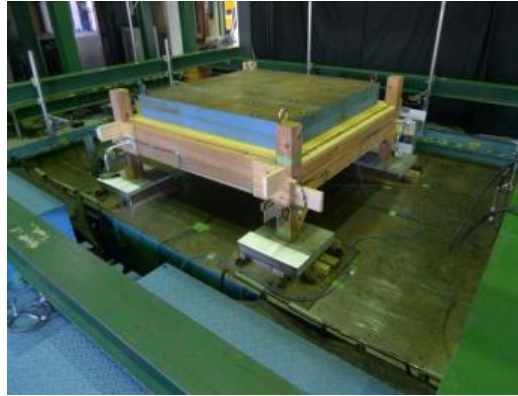
写真2 試験体を振動台に設置した様子
