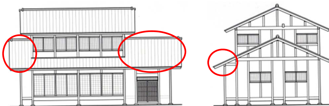
図 3 No.5 試験体の下屋（○印：左図が切妻屋根、右図が片流れ屋根）
