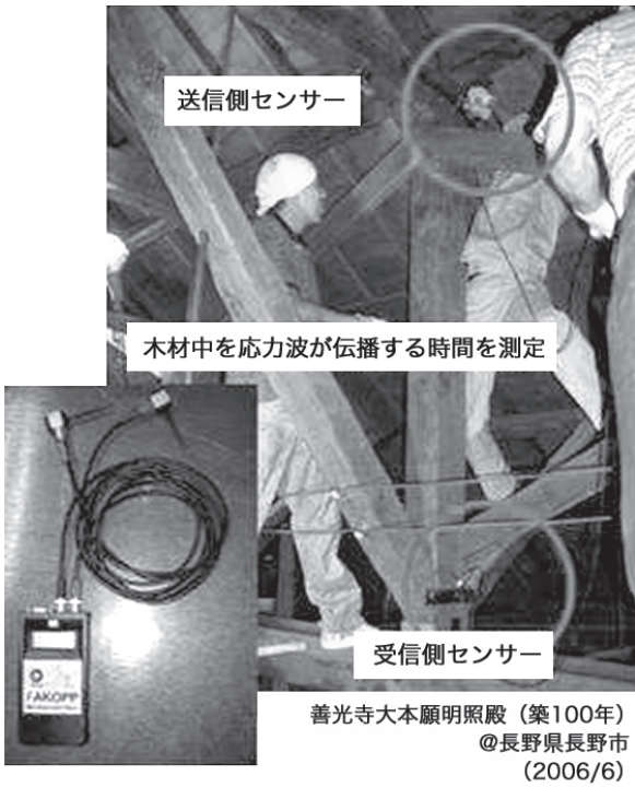
図6 応力波伝播速度の測定例
