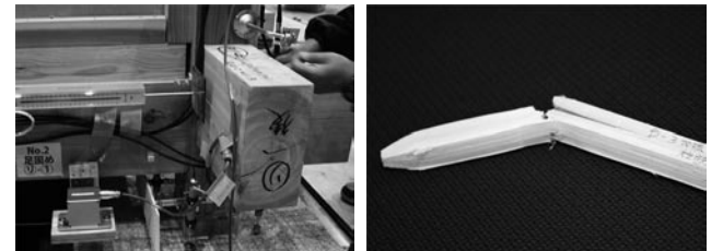
No.2 りー1 損傷を受けた足固め廻り No.2 折れた込栓
