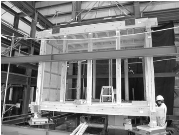
写真2 石場建て木造軸組試験体
