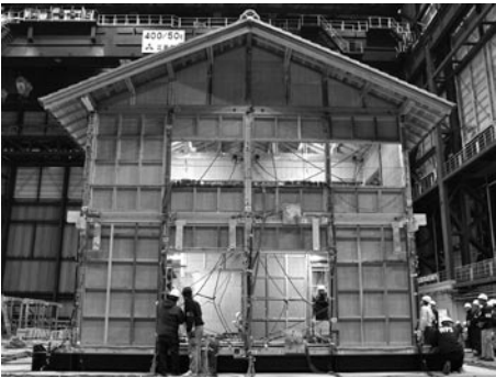
写真4 No.3 試験体の損傷観察風景
