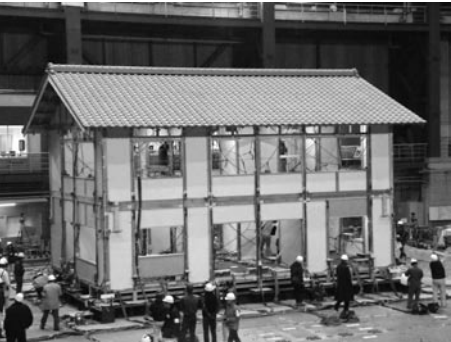
写真 5-1 No.4 試験体の損傷観察風景
