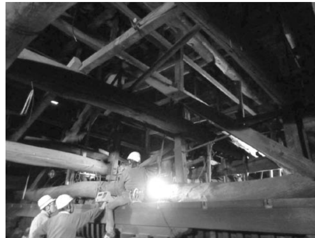
写真 2 応力波伝播特性測定状況
