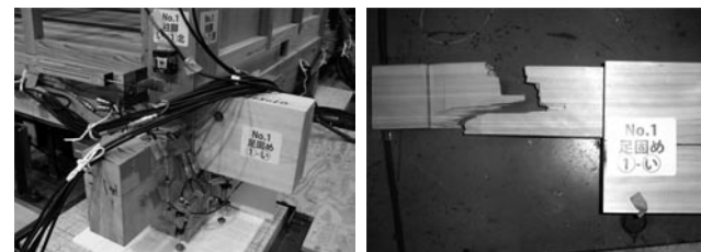
No.1 いー1 損傷を受けた足固め廻り No. 1 いー1 竿引き独鈎
